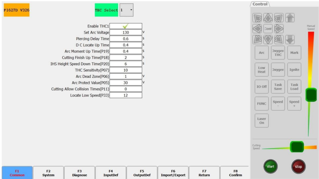
Figure 12.6 Height Modifier Parameter Configuration
